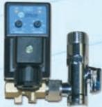
**ETHADRAIN<sup>trim</sup>:** scaricatore elettronico di condensa temporizzato. Esso permette di regolare in modo automatico ogni quanto tempo eseguire uno spurgo d'aria per scaricare la condensa accumulata e anche per quanto tempo prolungare tale spurgo.
